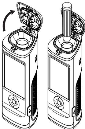
07. . Feche a porta para inserir o amostrador e começar o teste. **Obs.:** mantenha o instrumento na posição vertical enquanto a amostra estiver sendo lida.
