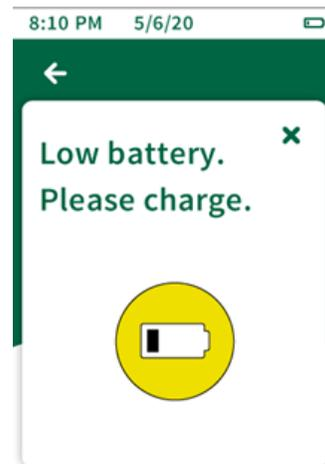
**Erro 07:** a bateria da unidade está esgotada, a unidade está desligando. Conecte a unidade ao carregador USB.
